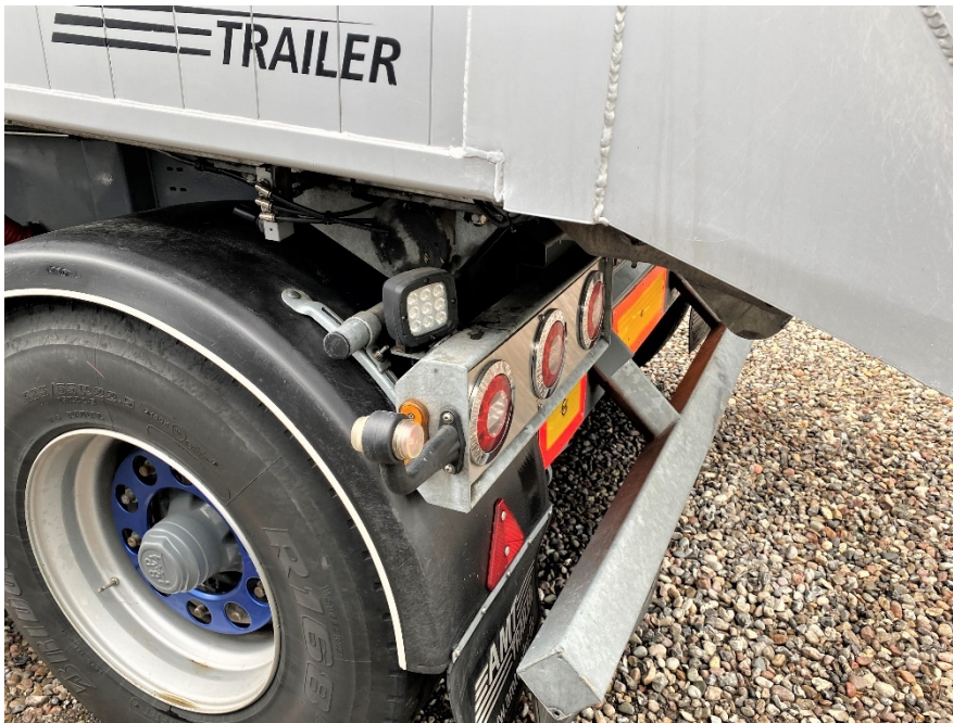
Billede 5: Kontroller/rengør ved lygter/skærme.
