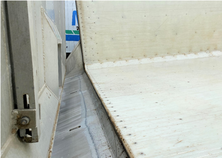
Billede 1: Rengør altid gummilister ved side/bag-smække
